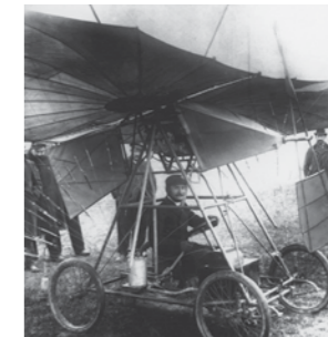
Traian Vuia la bordul aparatului „Vuia I”, cu care a realizat primul zbor mecanic complet din lume – pe 18 martie 1906, la Issy-les-Moulineaux
