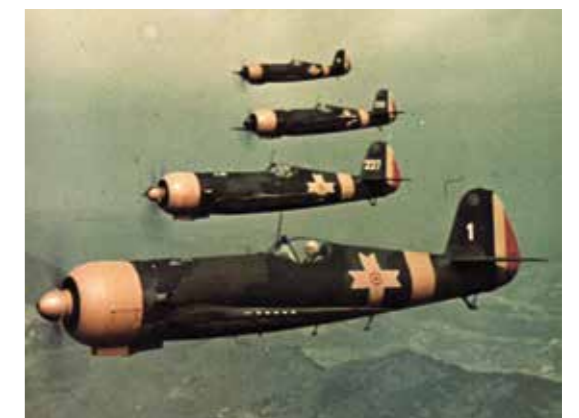
Avionul de vânătoare IAR - 80 este cel mai important produs al industriei aeronautice române a fost, pentru prima dată a secolului XX, avionul de vânătoare IAR - 80, fabricat de I.A.R. Brașov. Colectivul care a realizat prototipul a fost condus de inginerii Ion Grossu și Ion Coșereanu. A fost un avion complet metalic, cu tren de aterizare escamotabil și cu o elice tripală cu diametrul de trei metri și pas variabil. Prototipul, care a apărut în 1938, atingea 510 km/h, ocupând locul patru în lume la viteză. Testele s-au prelungit până în 1940, când comisia de omologare a ajuns la concluzia că avionul „este un bun interceptor, având în vedere viteza ascensională. Nu are vicii de pilotaj, făcându-l accesibil oricărui pilot de vânătoare bine antrenat, cu o instrucție asupra aparatului de bord”. A intrat în producția de serie în septembrie 1940, iar până la sfârșitul celui de-al Doilea Război Mondial, au fost produse aproximativ cinci sute de exemplare.
